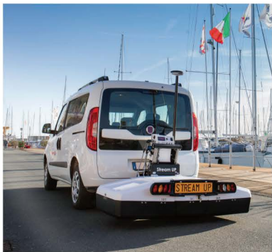
< 차량형 3D GPR 탐사 전경 >
