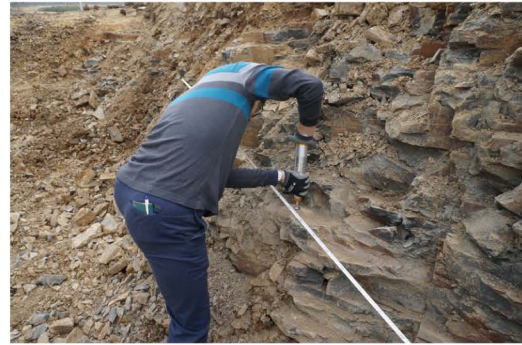
< 슈미트해머 측정 전경 >
